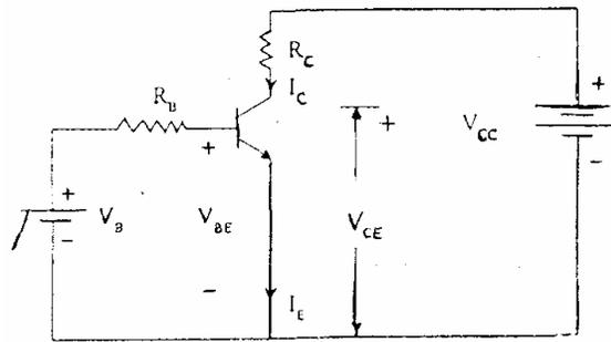
**Fig. 8 (b): Transistor Switch**
